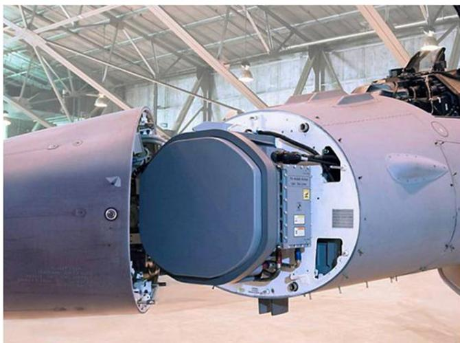
Fig. 1a. Radar AESA RACR (Raytheon's Advanced Combat Radar), integrado en versiones del F-16 de la USAF. Primer vuelo en la base de Edwards, California en julio de 2010. (Fuente: <http://www.raytheon.com>).
