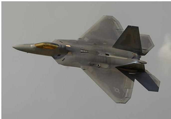
Fig. 4. F22 Raptor del Ala 3 de USAF en Elmendorf, Alaska. Incorpora el radar AN/APG-77, uno de los primeros radar AESA que se fabricó a gran escala (© 2010, Jeroen Oude Wolbers).
