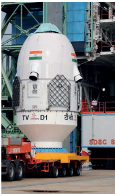
La Gaganyaan es llevada para su colocación sobre el cohete que la lanzaría. (Imagen: ISRO)
