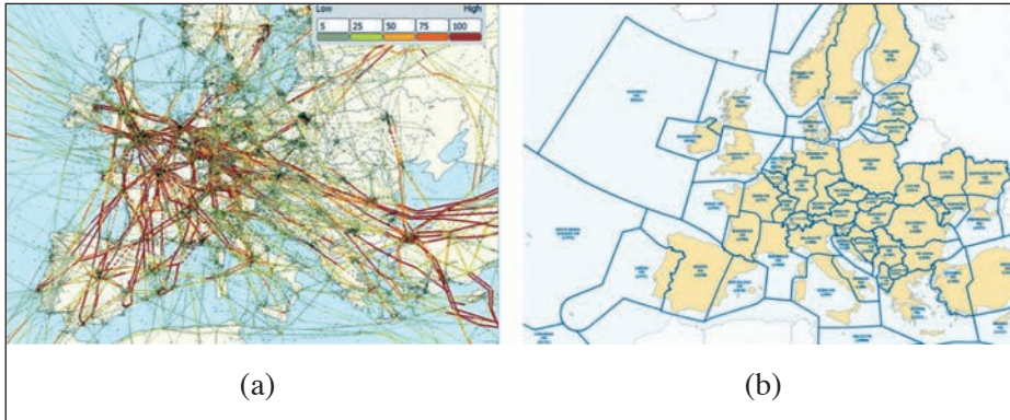
Figura 4. (a) Densidad de rutas de vuelos en tráfico aéreo europeo; (b) Regiones de información de vuelos (FIR) en Europa. (Fuente: STANDFUSS & SCHULTZ, 2018) (11)
