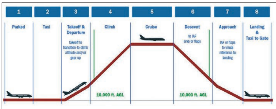
Figura 5. Fases de vuelo de una aeronave. (Fuente: adaptado de HANIFA, et al. , 2018) (12)
