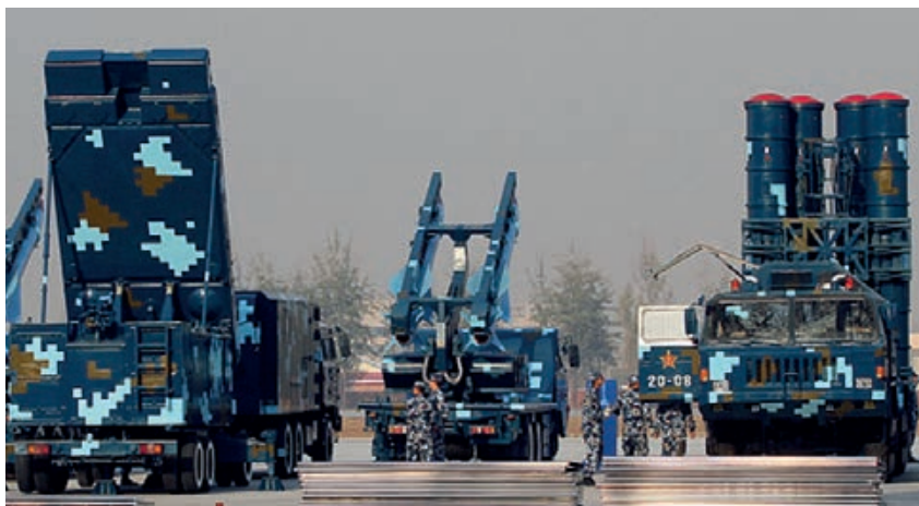
A la izquierda, los TEL (Transport Erector Launchers) del sistema HQ-12/KS-1A y el radar de ataque H-200. A la derecha, TEL del Sistema HQ-9 y su radar de ataque HT-233 (Imagen: Chinese Internet)
