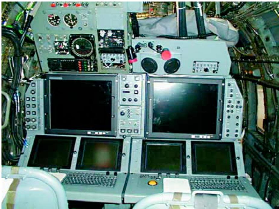
Disposición de las dos consolas del *Mk-7*. Nótese el sistema ESM sobre el operador de la izquierda.
