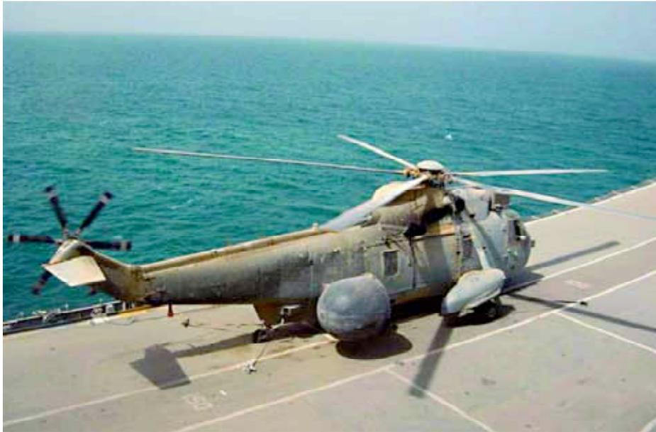
Helicóptero ASAC de la RN. Nótese la presencia del EAPS. (Foto obtenida durante operación TELIC).
