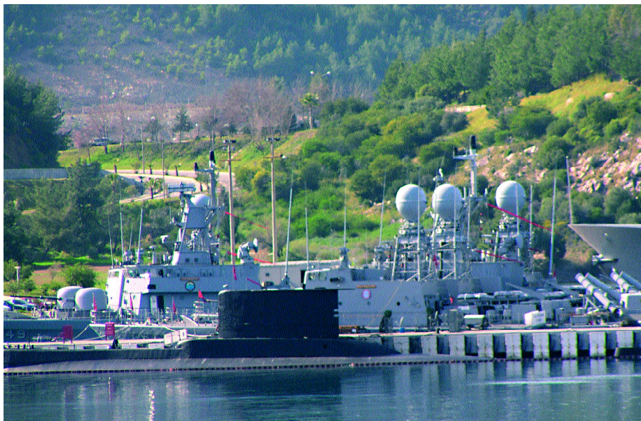
Fotografía de patrulleros turcos en puerto. Obsérvense las canastas de misiles a popa y los montajes de artillería. (Foto de la colección particular del autor).
