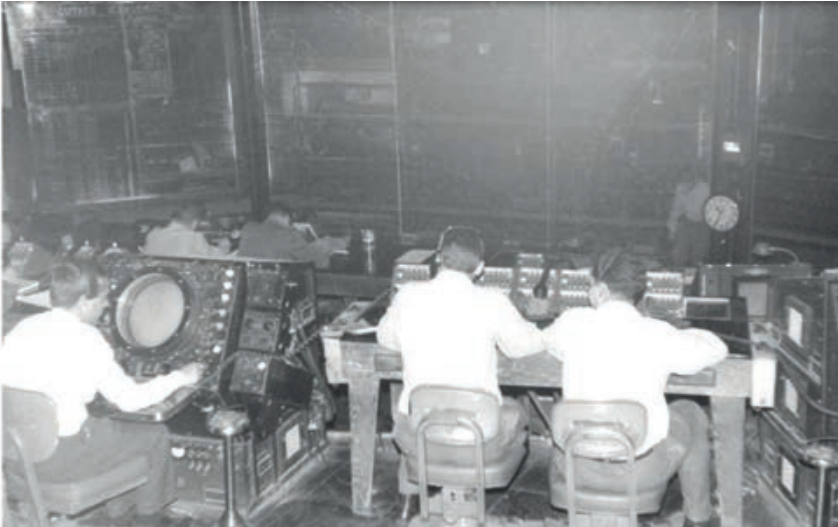
Sala de operaciones del EAC n.º 2 (Villatobas). Consolas UPA-35 y RHI de altura. En la misma sala donde estaba el plotter, los controladores de interceptación realizaban su función con las detecciones de los radares del asentamiento en las consolas UPA-35 y RHI de altura
