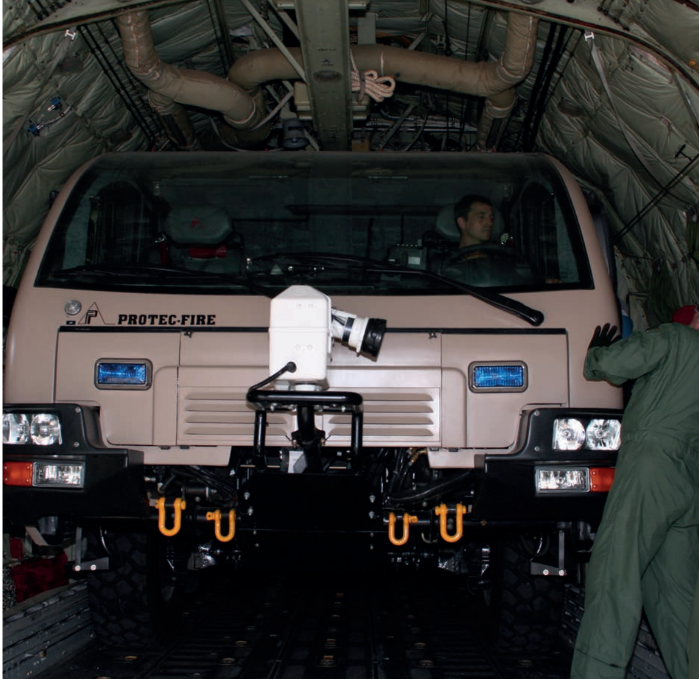
Pruebas de portabilidad de vehículo CI medio en el avión Hercules C-130 para su traslado a Qala I Naw
