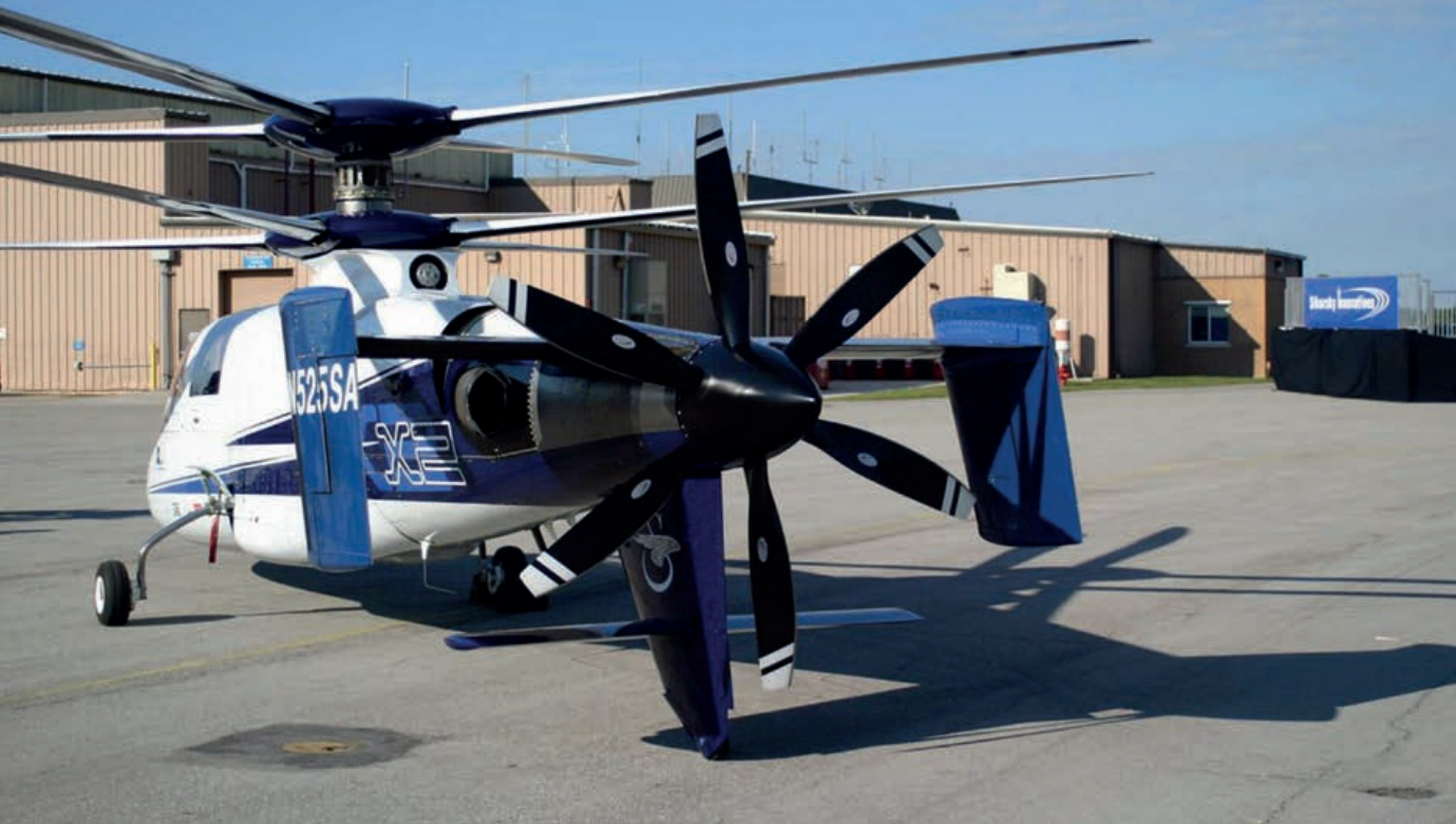
Detalle de la sección de cola del X2 en donde pueden apreciarse los detalles aerodinámicos de la hélice tipo pusher. (Imagen: Rotating Composite Technologies)
