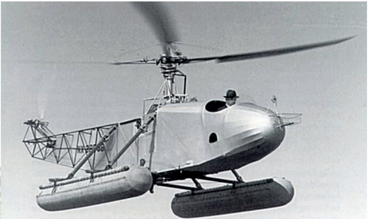
Sikorsky VS-300 con el propio Igor Sikorsky a los mandos. Cabe destacar la por entonces futurista configuración adoptada (un único motor, en este caso de 90 CV, proporcionaba potencia tanto al rotor principal como al de cola). El éxito de una serie de ensayos y modificaciones acorde con los resultados de estos, daría lugar al Sikorsky R-4, el primer helicóptero tal y como es concebido en la actualidad, producido en masa, siendo un total de 131 unidades las fabricadas). (Imagen: Sikorsky)
