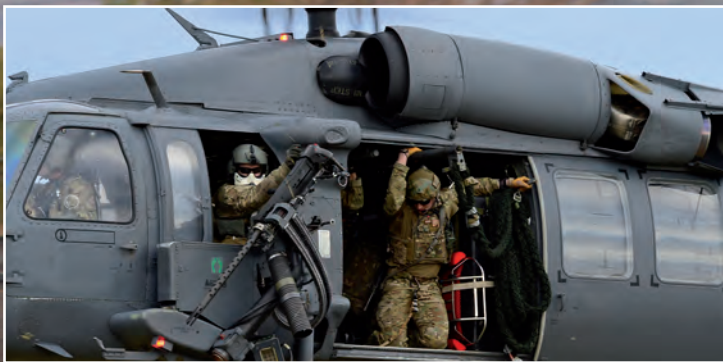
Los HH-60G pueden ser armados con ametralladoras de 12,70 m/m o con las Minigun de 7,62 m/m.
