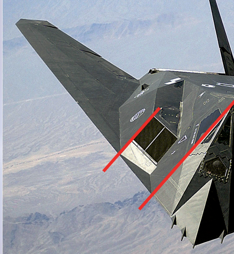
Imagen frontal de un F-117. En líneas discontinuas, se ilustra el concepto planform alignment en base a
