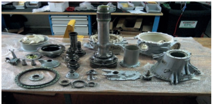
Caja de Transmisión Principal desmontada.
