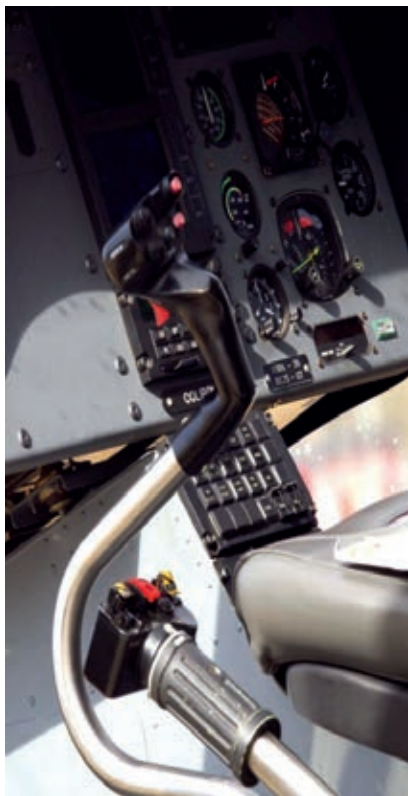
Detalle del interior de la cabina con los mandos de vuelo y la instrumentación. Cabeza del rotor del EC-120.
