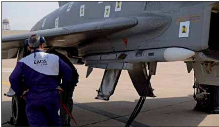
Ensayos aerodinámicos del Meteor en el avión de serie instrumentado IPA 4 en Morón.
