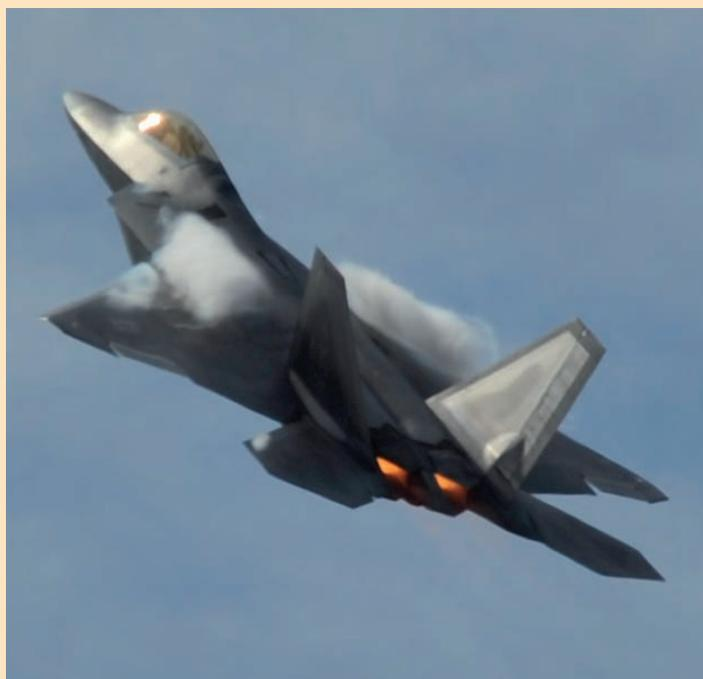
El Raptor representa una evolución significativa en el diseño de plataformas invisibles al radar "stealth", ya que supone incorporar esta tecnología sin comprometer las características aerodinámicas. Las capacidades para volar con ángulos de ataque elevados, de hasta sesenta grados, fueron confirmadas durante la fase de evaluación
