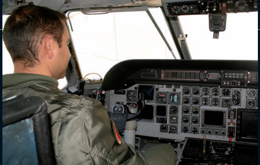
EL TABLERO DE MANDOS DEL VIGMA HA SIDO DOTADO DE UNA SISTEMA MEDIANTE EL CUAL PILOTO Y COPILOTO PUEDEN OBSERVAR LAS IMÁGENES RECOGIDAS POR EL SISTEMA FITS.
