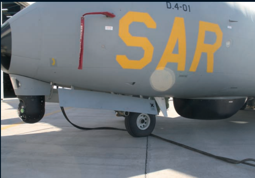
DETALLE DE LA PARTE INFERIOR DEL VIGMA, DONDE SE PUEDE VER LA TORRETA Y EL RADAR DE BÚSQUEDA.
