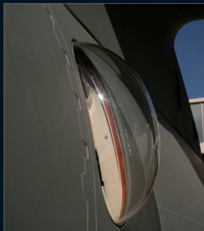
LA MAYORÍA DE LAS VENTANAS DEL FUSELAJE SE HAN CERRADO, INSTALÁNDOSE SENDAS VENTANAS DE OBSERVACIÓN EN LA PARTE TRASERA EL FUSELAJE.
