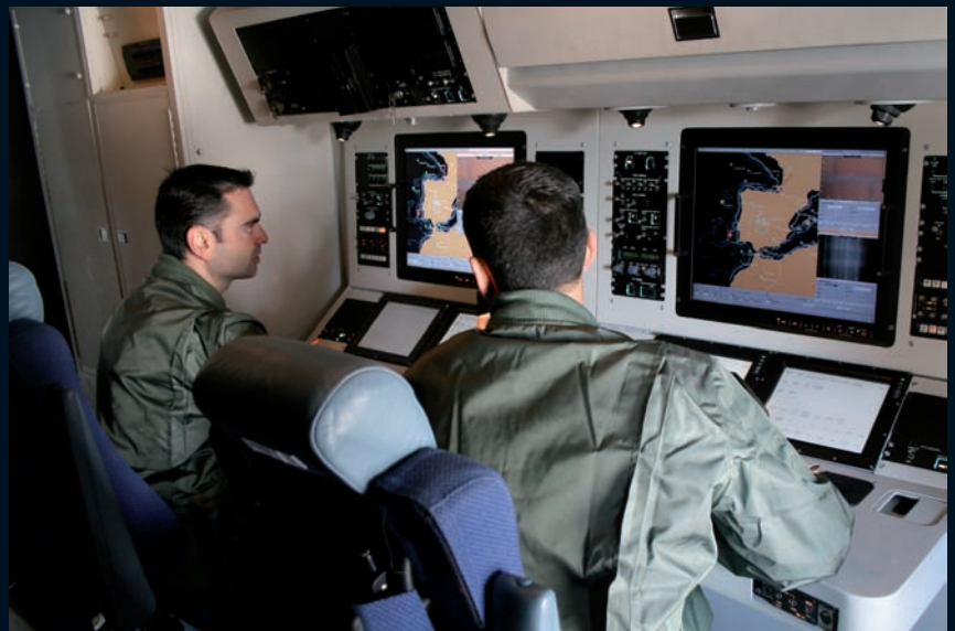
EL VIGMA ESTÁ DOTADO DE SENDOS PUESTOS DE CONSOLAS, DEL SISTEMA FITS, MEDIANTE EL CUAL SE GESTIONA LA INFORMACIÓN RECOGIDA POR LOS SENSORES DEL APARATO.
