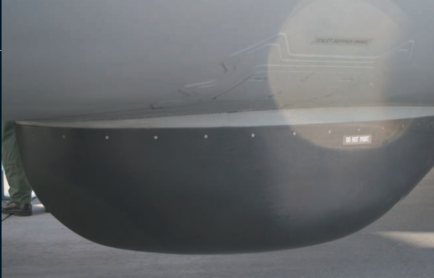
EL VIGMA ESTÁ DOTADO DE UN RADAR DE BÚSQUEDA SITUADO BAJO EL FUSELAJE.
