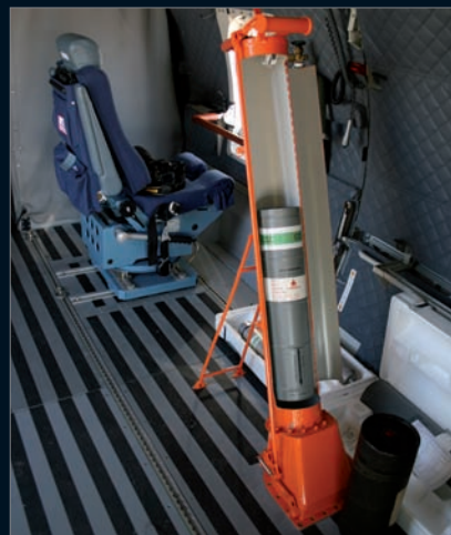
DETALLE DEL SISTEMA DE LANZAMIENTOS DE BOYAS Y BALIZAS, INSTALADO EN LA PARTE TRASERA EL FUSELAJE.
