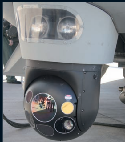
DETALLE DE LA TORRETA, SITUADA BAJA EL MORRO, QUE ACOGE UN SISTEMA DE VISIÓN ELECTRO ÓPTICO (TV) Y UNO DE VISIÓN NOCTURNA (FLIR).
