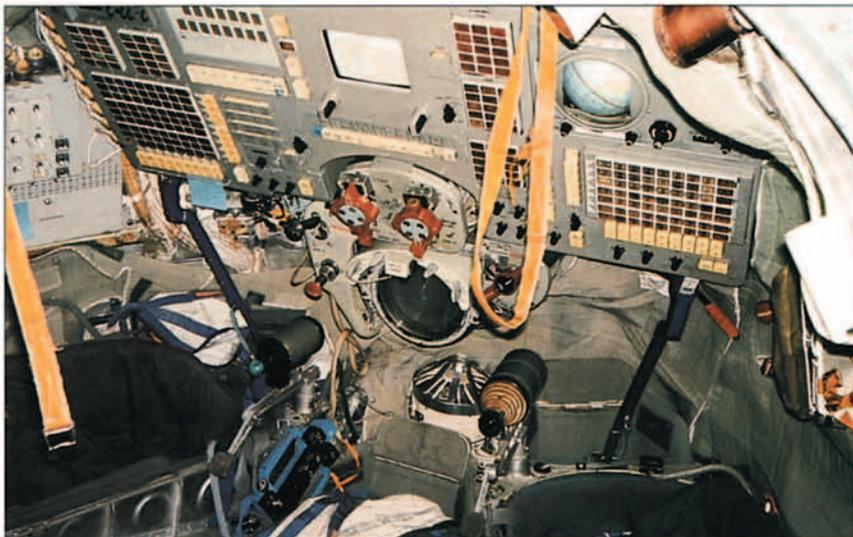
Panel de control del simulador de una cápsula Soyuz.
