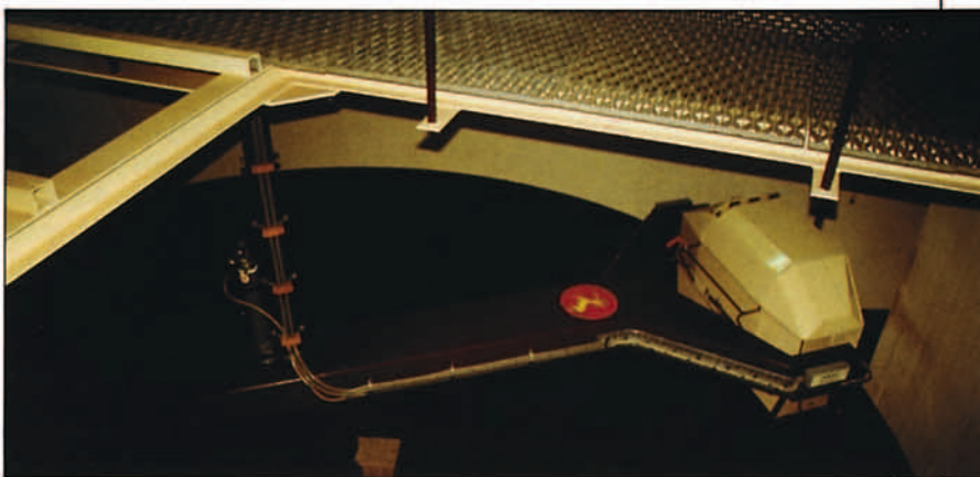
Foto 2. Centrifuga de 4 m. de radio usada para entrenamiento de pilotos de caza. Los candidatos a astronautas deberán someterse a esta prueba.
