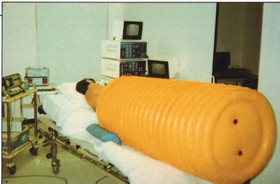
Foto 1. El Aparato de Presión Negativa en la parte inferior del cuerpo (LBNP) se usa tanto como equipo de contramedidas fisiológicas como para selección de astronautas.
