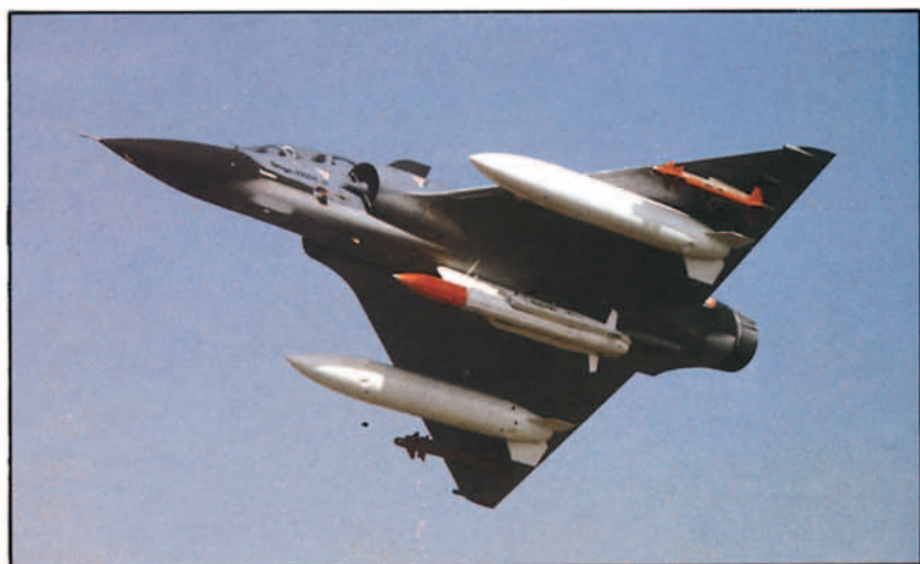
El Mirage 2000N con el misil ASMP (Air-Sol Moyenne Portée) que carga una cabeza nuclear a velocidad supersónica.
