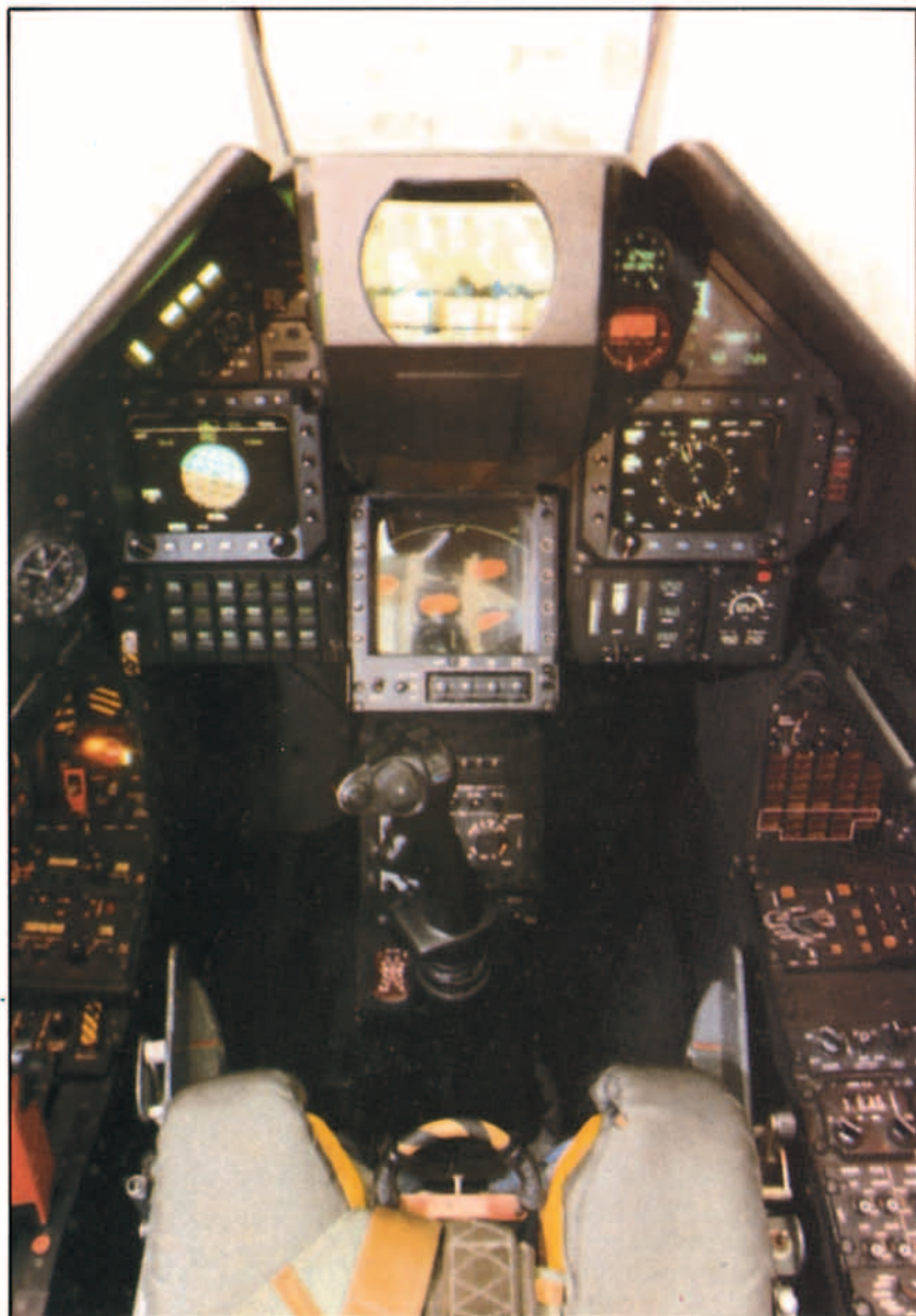
El Mirage 2000N incorpora sistemas avanzados de presentación de información al piloto, según el concepto APSI (Advance Pilot System Interface).
