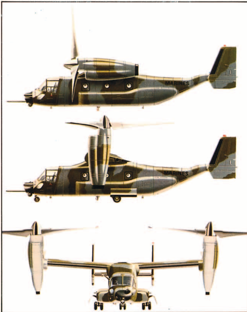
Avión V22 Bell-Boeing "Osprey" provisto de dos motores turbohélice basculantes T406-AD-400 de 6.000 SHP cada uno. Se harán seis prototipos, el primero de los cuales voló en junio de 1988. El Gobierno USA tiene planificado adquirir 1.213 aviones de este tipo, para el Ejército. (Fig. 7).
