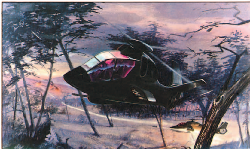
Helicóptero LHX fabricado por el consorcio Boeing-Sikorsky propulsado por dos turbojets Avco Lycoming APW 34 de 1.200 SHP cada uno. El 19 de agosto de 1988 se acordó dotarle del moderno sistema de armamento ASD. En octubre fue firmado con la USAF, un contrato para hacer demostraciones durante 18 meses. (Fig. 8).
