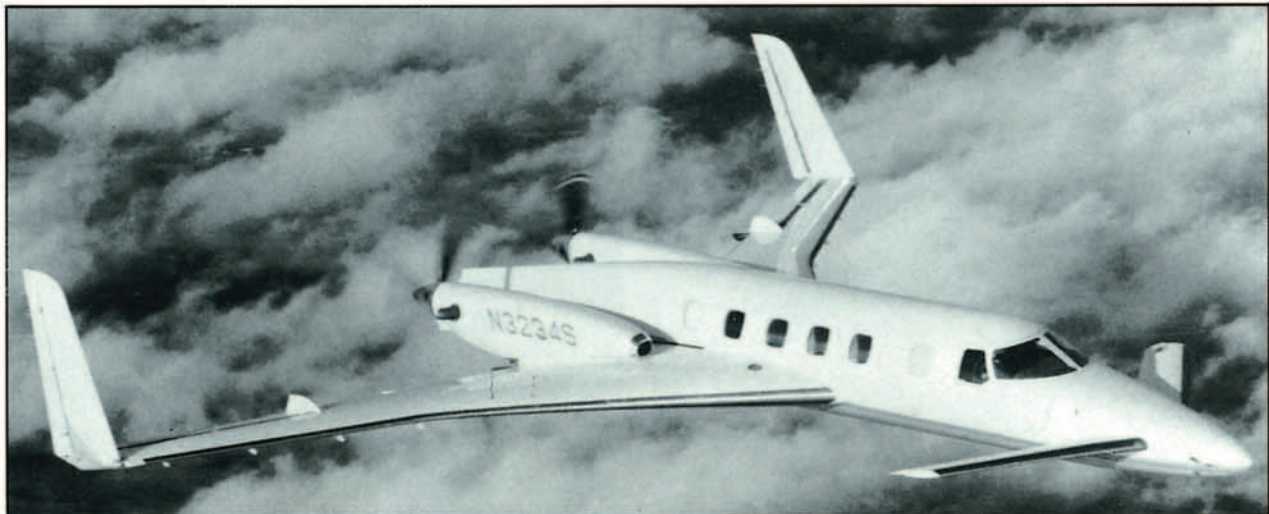
El Beech Starship, de Beech Aircraft. Además de la "revolucionaria" configuración aerodinámica, tiene un alto porcentaje de materiales "composites". Obtuvo el certificado de tipo el 19 de junio de 1988. (Fig. 16).
