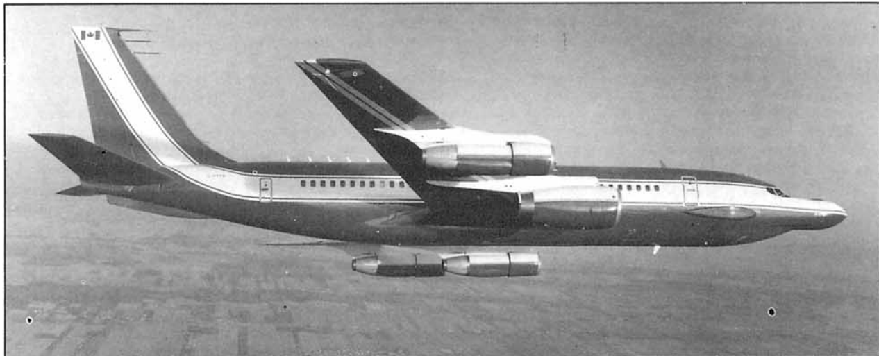
Pratt Whitney de Canadá está probando sobre un Boeing 720, un motor V-2500 del consorcio IAE, del cual PW es el responsable principal. Obsérvese el mayor tamaño del V-2500 montado en la posición n° 3 de los motores, respecto de los otros tres PW JT3C-7 ya veteranos. (Fig. 18).
