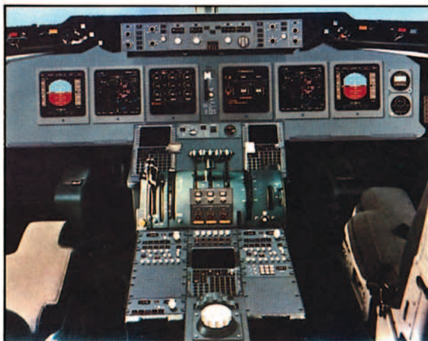
En el trireactor comercial de McDonnell Douglas MD-11, comenzó a montarse el "cockpit" el 9 de marzo de 1988. Como puede observarse en la fotografía, toda la instrumentación es por pantallas CRT (Cathode Ray Tube). (Fig. 14).
