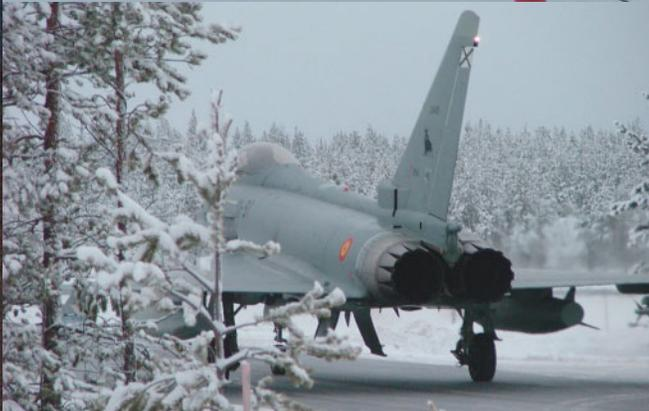
*Se aprovecharon las instalaciones de Vidsel para realizar ensayos de operación sobre nieve compacta que en principio no estaban previstos alcanzándose carreras de hasta 80 kts. Excelente comportamiento.*
