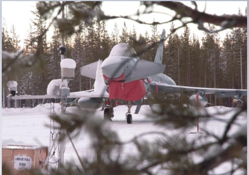
*El avión debía estar expuesto durante al menos 9 horas a las bajas temperaturas para poder validar el ensayo.*
