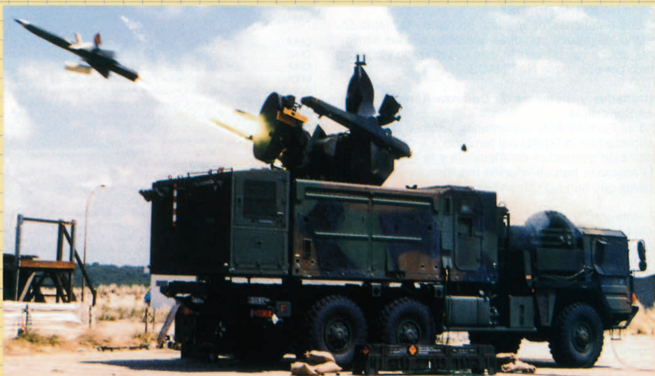
ROLAND es un sistema de armas Superficie-Aire autónomo con un alcance de hasta 11 km, todo tiempo, multivehículo, multisensor (Radar, IR, TV, Laser) y multimisil, bajo intensas IRCM y ECM y con total compatibilidad C3I. El puesto de tiro Roland consiste en una cabina aerotransportable, con resistencia NBQ y todos los medios necesarios para el disparo tierra-aire.
