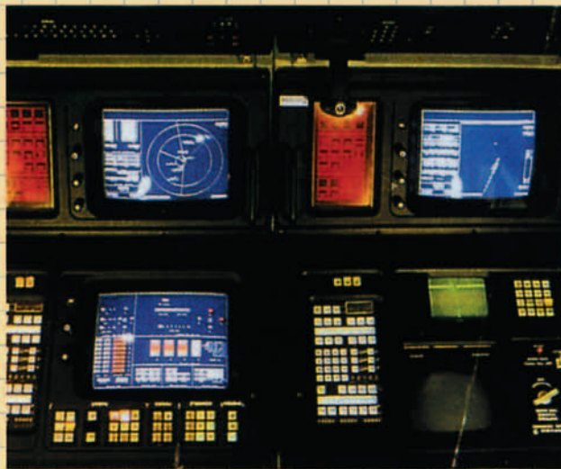
Una unidad de Fuego típica NASAMS comprende un Radar TPQ 36A(3D) con un haz de lápiz muy estrecho, un Centro de Distribución de Fuego (FDC) -en la fotografía- y tres lanzadores con 6 misiles AMRAAM cada uno.
