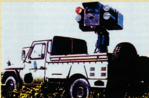
Sistema ASPIC de tiro automático para misiles de corto alcance. Operativo con misiles de muy corto alcance: Starstrek, Starburst, Stinger, Mistral, con una elevada potencia de fuego, capacidad día/noche y modo autónomo y coordinado contra aviones a muy baja cota y helicópteros.
