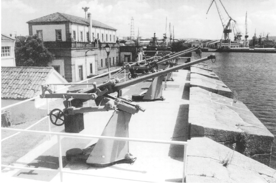
Los cañones de 3,7 cm L/85 R.B. Bazán de la batería de salvas del arsenal de Ferrol. Con más de sesenta años, estos veteranos siguen disparando diariamente —sin fines bélicos— al orto y al ocaso. (Foto: autor.)
