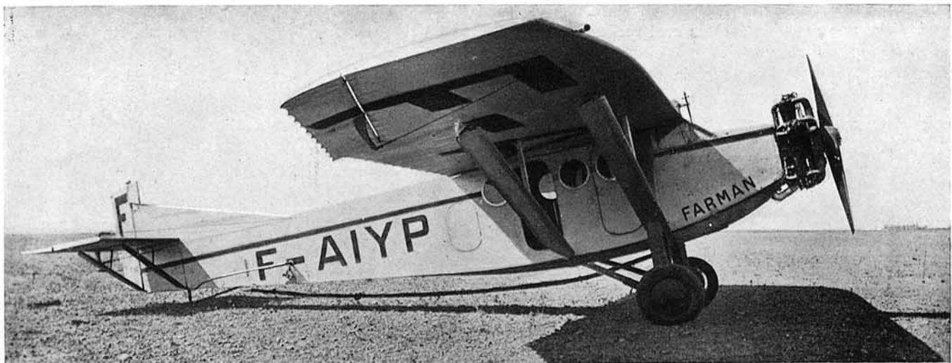
Un avión provisto de piloto automático. Bajo el fuselaje se advierte, recogida, la larga pértiga que sirve para el aterrizaje, y a la derecha del fuselaje, cerca de la cola, otra más pequeña que se utiliza para el despegue.
