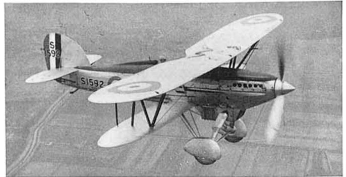
Monoplaza de caza, naval, Hawker «Nimrod», con motor Rolls Royce «Kestrel». Tipo derivado del «Fury».
