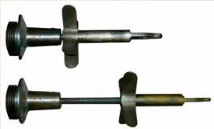
En la parte superior, espoleta S-1 en seguridad, abajo la misma espoleta, con la hélice-seguro roscada hasta su tope, dispuesta para la detonación.
