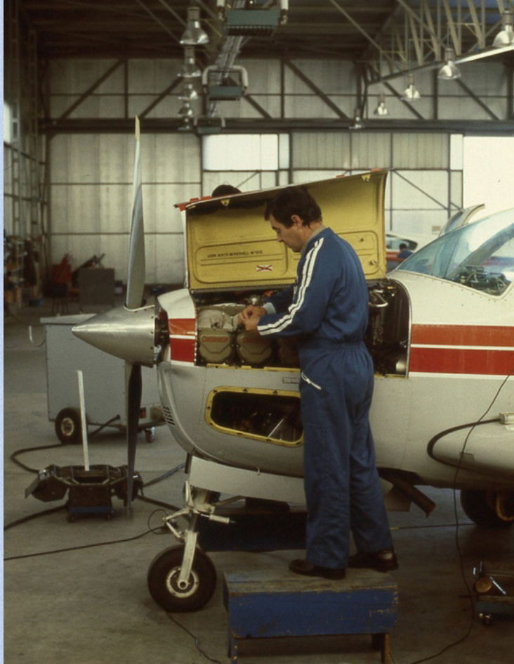
Reparando un motor de Bonanza
