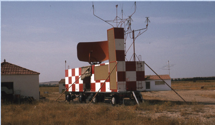
Remolque que albergaba el Radar para GCA
