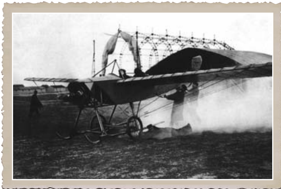
→ Otra interesante fotografía, con el motor del Bristol Prier en marcha, los "hombres calzo" luchando para aguantar las ruedas y otros operarios (los "portacolas") manteniendo el fuselaje horizontal, todo ello en medio de una enorme polvareda (foto: Mundo Gráfico nº 12, 17-1-1912).
