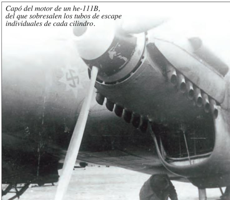
Capó del motor de un he-111B, del que sobresalen los tubos de escape individuales de cada cilindro.
