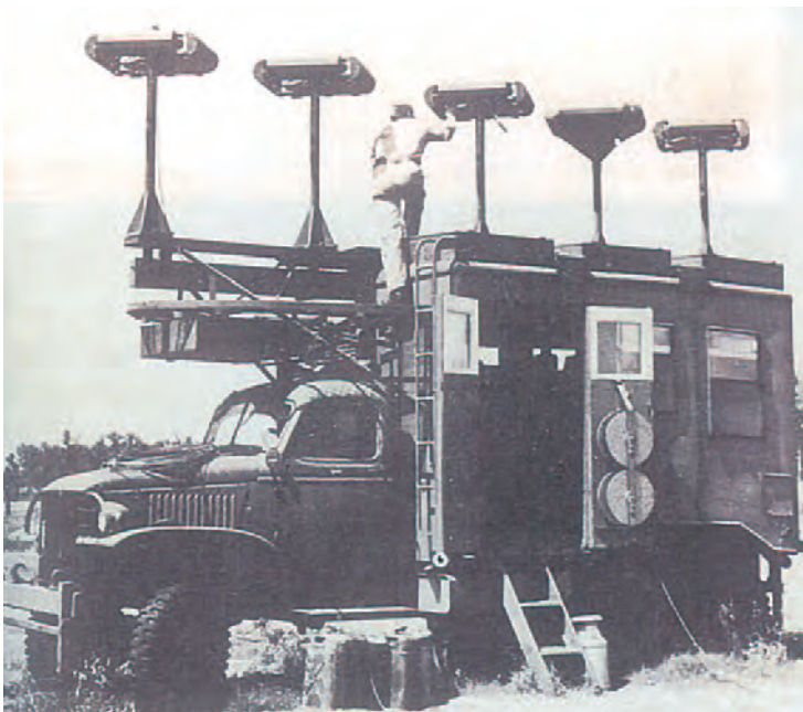
Lámina 4. Una vista del equipo militar ILS-SCS-51 que estuvo prestando servicio en el Aeropuerto de Barajas -Madrid en los años cincuenta. Fuente: Historia del Transporte Aéreo. Pag.87
