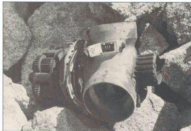
Do-217. Engranajes entre el motor y las palas de la hélice.
