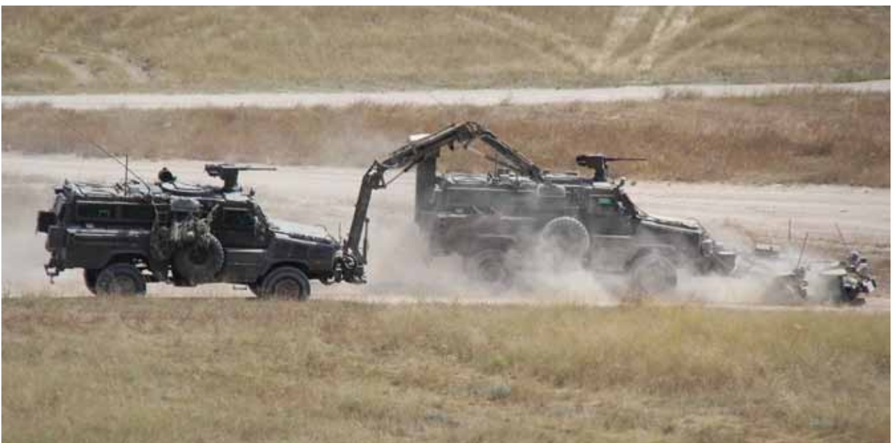
Limpieza de rutas con RG-31 con sistema Roller (rodillos antiminas) y brazo investigador
