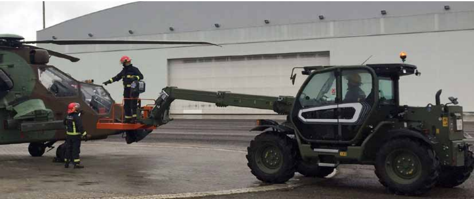
El vehículo de rescate cuenta con un brazo proyectable de hasta nueve metros
